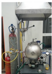
Obr. 5 Výbuchový autokláv VA-20
