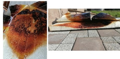
Zmena vnútorného jadra a zmena hrúbky PUR panelu PUR panel je bez požiarnej odolnosti
