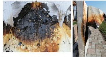
Zmena vnútorného jadra a zmena hrúbky PIR panelu Predpokladaná požiarne odolnosť 30/D3
