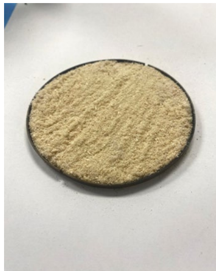
Obrázok 1 Vzorka drevného smrekového prachu zarovnaná v kovovom prstenci o hrúbke 5 mm
