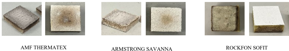
Obr. 7 Vzorky po zaťažení rubovej strany – ukážka namáhanej a odvrátenej strany
