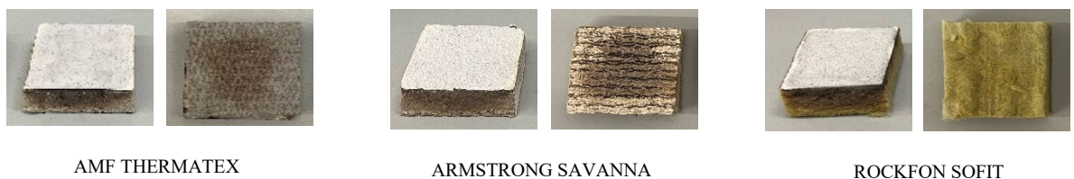
Obr. 5 Vzorky po zaťažení lícnej strany – ukážka namáhanej a odvrátenej strany
