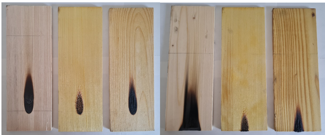
Obr. 1 Fotodokumentácia vzoriek po skúške zapáliteľnosti pri zaťažení na plochu (vľavo) a hranu (vpravo) - neošetrená vzorka, Boehemit Antiflash, Boehemit Pyro
