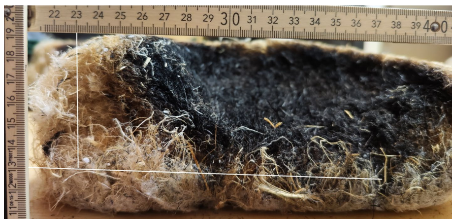
Obrázok 8 Hĺbka poškodenia spôsobeného v konopnom materiáli
