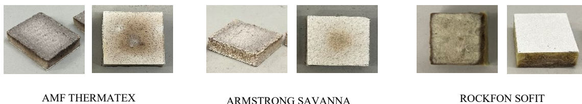
Obr. 7 Vzorky po zaťažení rubovej strany – ukážka namáhanej a odvrátenej strany
