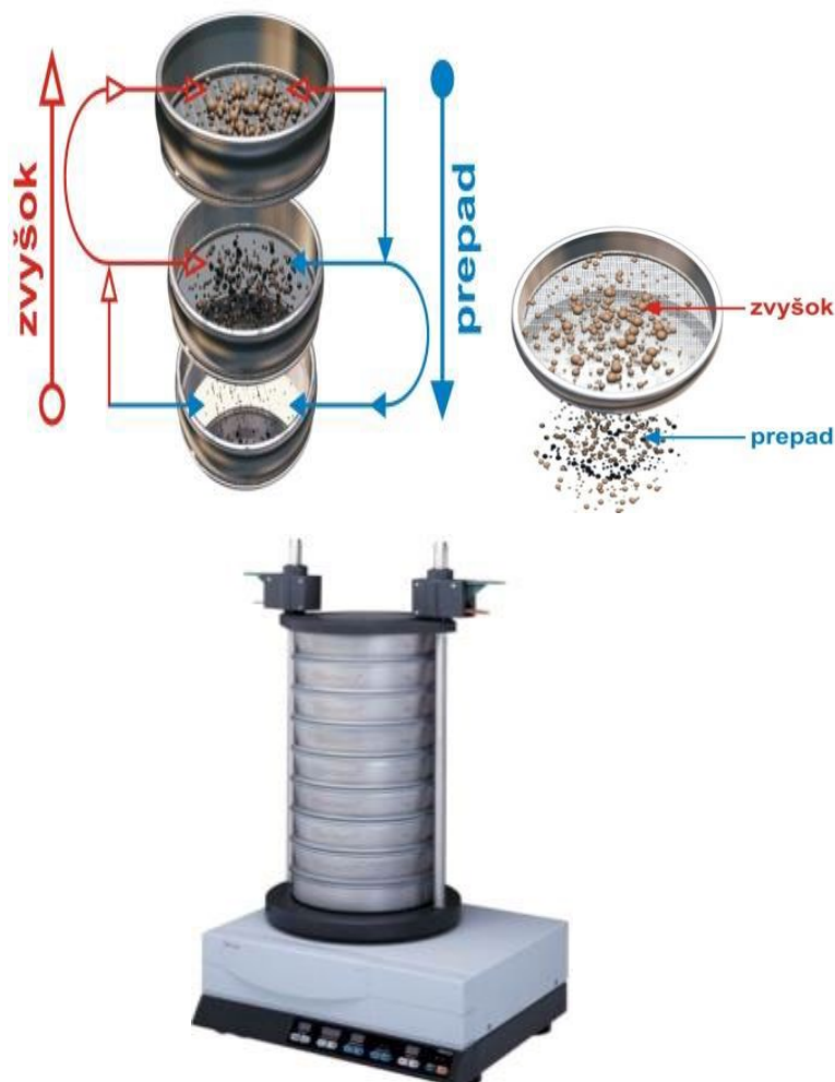
Obrázok 3 Automatický vibračný sitovací stroj Retsch AS 200 control, grafické znázornenie pojmu zvyšok a prepad (Jobbágyová, 2008) (Marková et al, 2018)
