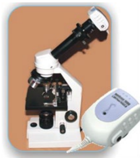
Obrázok 5,6 Mikroskop SM1 s inštalovanou kamerou MoticCam 1000 (Marková et al, 2018)
