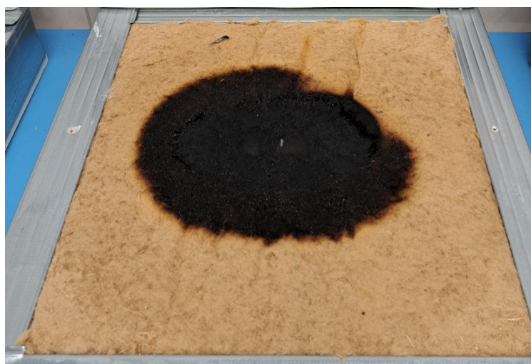
Obrázok 6 Spôsobené poškodenie na materiál z drevovlákna
