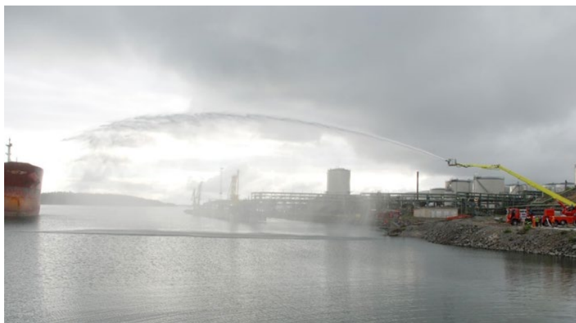
Obrázok 4. Zdvíhacia plošina s veľkou hasiacou kapacitou pri zásahu (model Bronto F-SE) [8]
