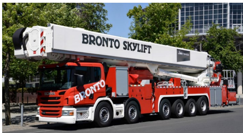
Obrázok 2. Výšková zdvíhacia plošina (model Bronto F-HLA) [8]
