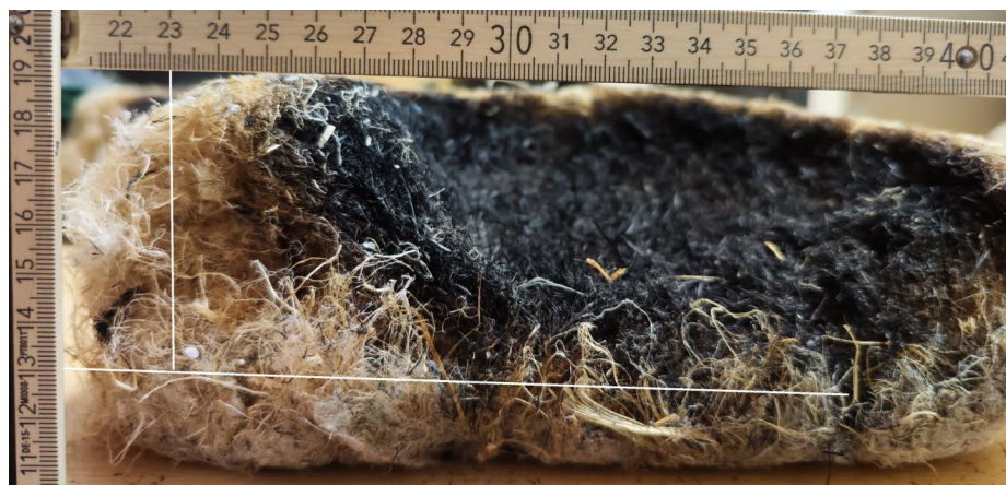
Obrázok 8 Hĺbka poškodenia spôsobeného v konopnom materiáli
