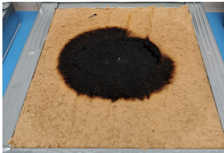
Obrázok 6 Spôsobené poškodenie na materiál z drevovláknna
