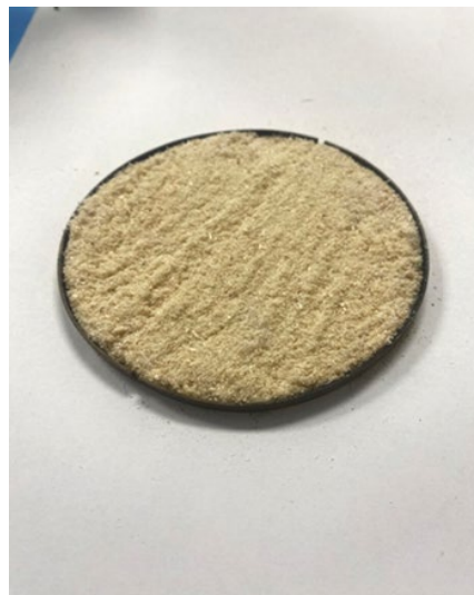
Obrázok 1 Vzorka drevného smrekového prachu zarovnaná v kovovom prstenci o hrúbke 5 mm
