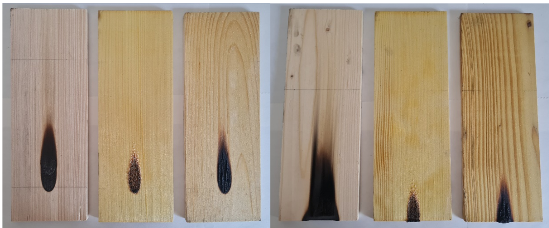
Obr. 1 Fotodokumentácia vzoriek po skúške zapáliteľnosti pri zaťažení na plochu (vľavo) a hranu (vpravo) - neošetrená vzorka, Boehemit Antiflash, Boehemit Pyro
