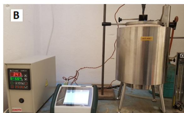
Obr. 1 Príprava vzoriek a zariadenie na stanovenie teploty vzplanutia a teploty vznietenia podľa STN ISO 871
