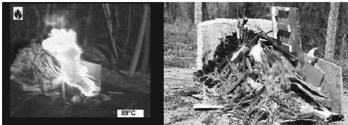
Obr. 6 Požiar v čase 4 sekundy po zapálení Fig. 6 The fire with 4 seconds after initiation
