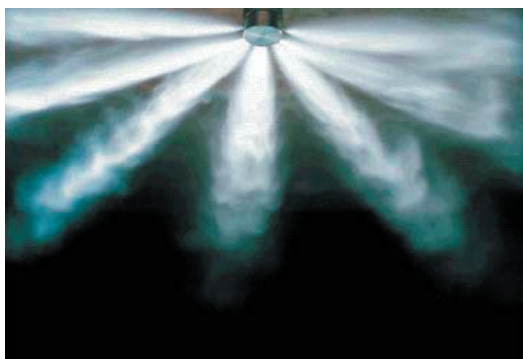
Obrázok 2: Vypustenie látky Novec™ 1230 Fire Protection Fluid
