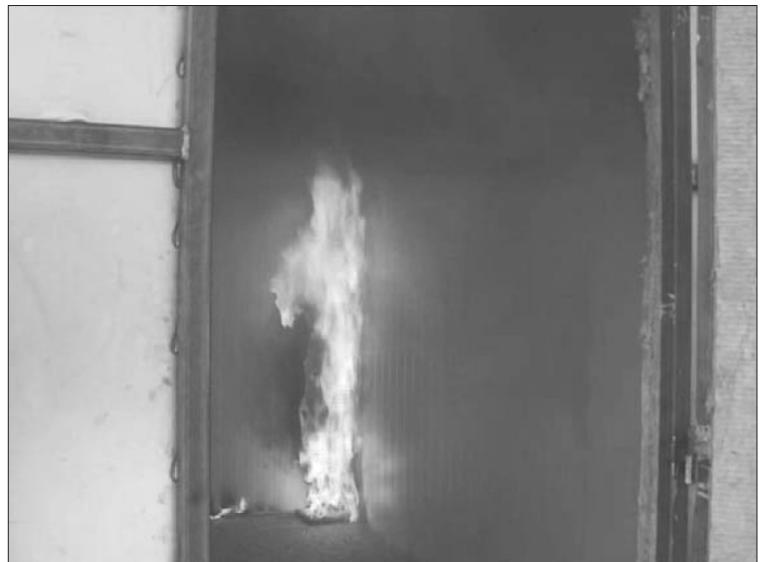
Simulácia požiaru v bunke s PIR izoláciou
