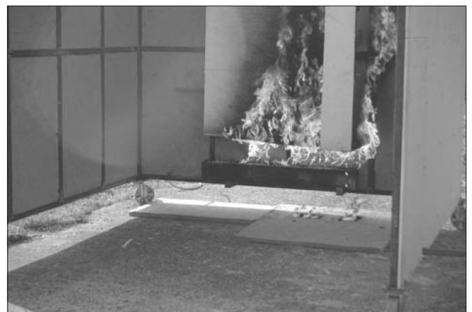
Správanie sa KZS z penového polystyrénu počas pôsobenia horáka
