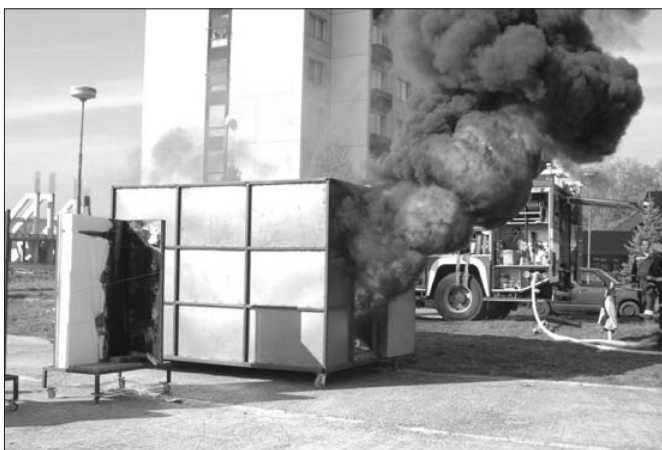
Spätný výbuch – backdraft v bunke s PIR izoláciou
