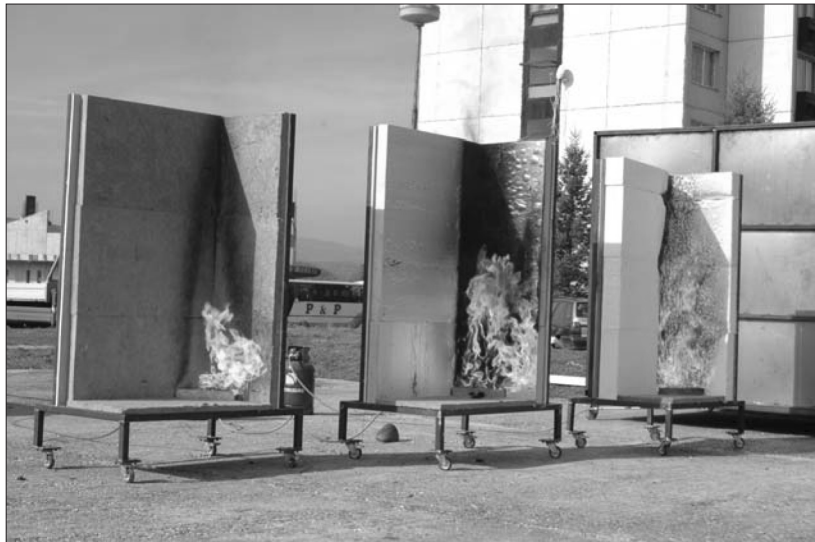
Rozdielna reakcia na oheň troch druhov izolačných materiálov
