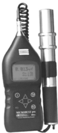
Obr. 8 Prístroj „Microdust Pro“ na meranie prašnosti v reálnom čase
