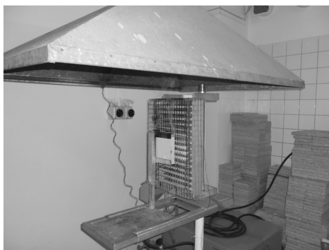
Obr. 3 Experimentálne meranie na elektrickom radiačnom paneli
