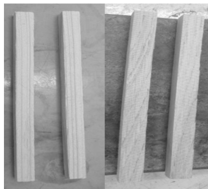
Obr. 1 Skúšobné telesá (vľavo smrek obyčajný, vpravo dub zimný)
