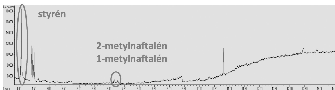
Obr. 5 Chromatogram plyných produktov z pyrolýzy vzorky PS5 zaťažovaného teplotou 200 °C
