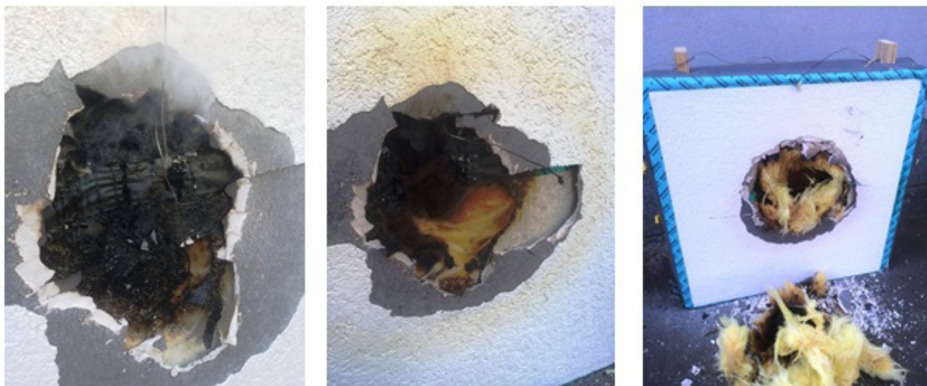
Obr. 4 Kontrola stavu a miera poškodenia jednotlivých vrstiev vzorky č. 1
