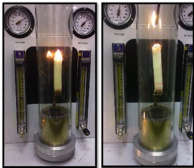
Obr. 3 Testovanie Nawapur Wellnes 4835 pri LOI 18 % obj, 17 % obj., 16 % obj
