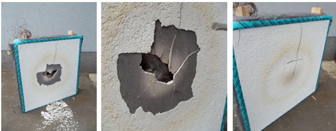
Obr. 7. Miera poškodenia vnútorných vrstiev vzorky č. 2
