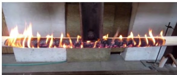
Obr. 33 Plameňové horenie vzorky (Tereňová a kol. 2012)
