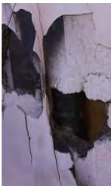
Obr. 67 Vzorka A po ukončení skúšky - vľavo tlenie dreveného stĺpika, vpravo zuhoľnatý drevený stĺpik po úplnom vychladnutí vzorky (Tereňová a Hakoš 2016)
