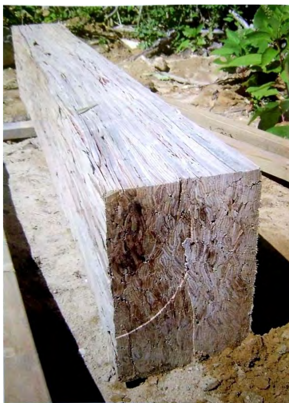
Obr. 10 Nosník z lisovaných dýhových pásov (Štefko a kol. 2006)
