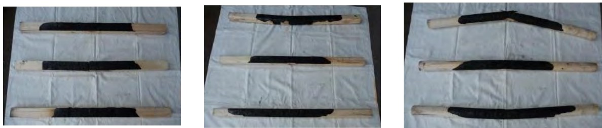
Obr. 36 Vzorky testovaných prierezov nosníkov po ukončení experimentu vľavo štvorcový prierez, vstrede prierez so zaoblenými hranami, vpravo okrúhly prierez (Tereňová 2015)
