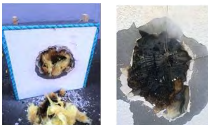
Obr. 57 Vzorka č. 2 – 1. alternatíva po ukončení skúšky (vpravo degradácia izolačnej platne Entkopplung) (Tereňová a Gracovský 2017)
