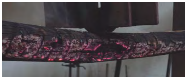
Obr. 34 Tlenie zuhoľnatenej vrstvy (Tereňová a kol. 2012)
