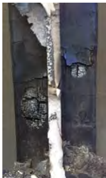
Obr. 67 Vzorka A po ukončení skúšky - vľavo tlenie dreveného stĺpika, vpravo zuhoľnatý drevený stĺpik po úplnom vychladnutí vzorky (Tereňová a Hakoš 2016)
