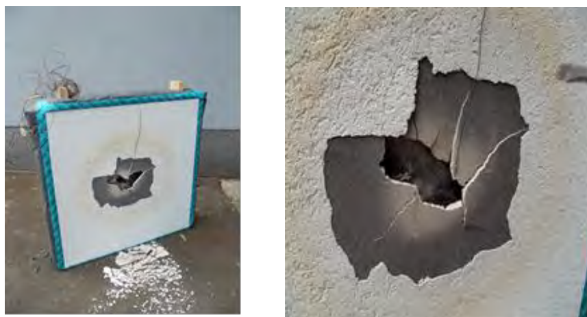
Obr. 58 Vzorka č. 2 – 2. alternatíva po ukončení skúšky (vpravo zadymená tepelná izolácia za papierovou parozábranou) (Tereňová a Gracovský 2017)
