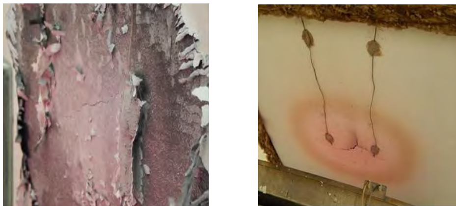
Obr. 52 Porušenie celistvosti skúšaných vzoriek vľavo vzorka č. 1 – 1. alternatíva krátko po uplynutí 30. minúty, vpravo vzorka č. 1 – 2. alternatíva v 30. minúte (Tereňová a Gracovský 2017)
