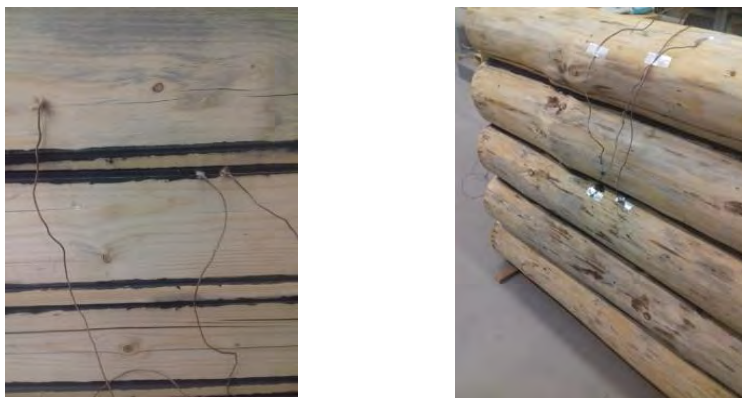
Obr. 39 Umiestnenie termočlánkov na vzorkách (Tereňová a kol. 2018)
