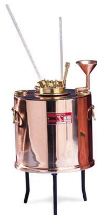
Obrázok 28 Prístroj podľa Abela (PTEÚ MV SR 2014)
