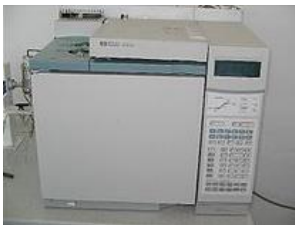
Obrázok 40 Plynový chromatograf (TÚPO 2014)
