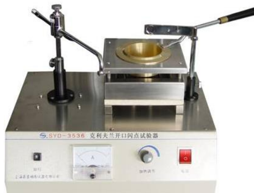
Obrázok 24 Prístroj podľa Clevelanda (PTEÚ MV SR 2014)
