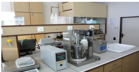
Obrázok 31 Prístroj Mackey (PTEÚ MV SR 2014)
