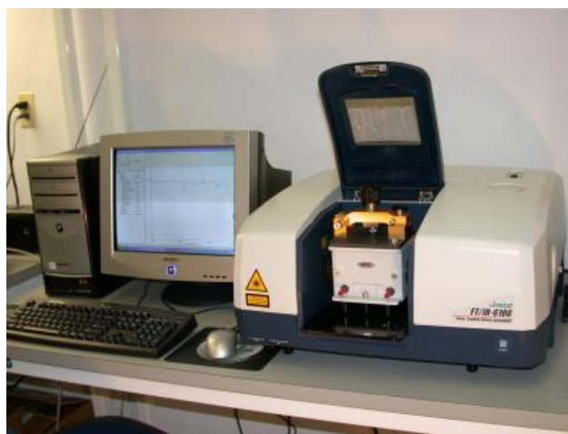
Obrázok 35 Infračervený spektroskop (TÚPO 2014)
