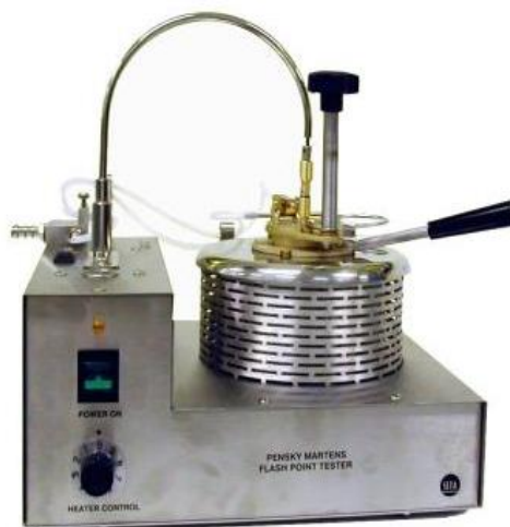
Obrázok 25 Prístroj podľa Penského-Martensa (PTEÚ MV SR 2014)
