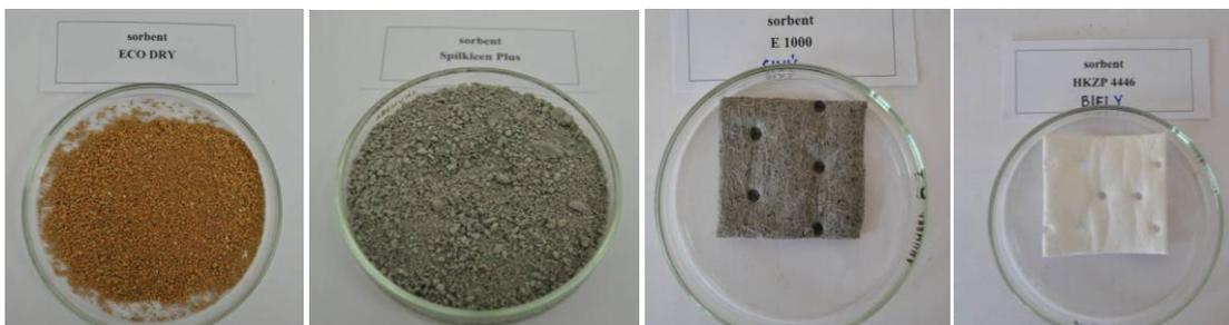
Obrázok 2 Sorbent ECO DR, sorbent Spilkleen Plus, Sorbent E 1000 a sorbent HKZP 4446 (Zdroj: Ganzarčík, 2012)
