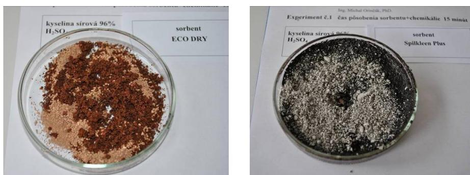
Obrázok 2 Sorbent ECO DRY a Spilkleen Plus kontaminovaný  $H_2SO_4$  (Zdroj: Ganzarčík, Orinčák, 2012)
