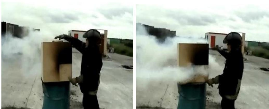
**Figure 6 Handling mini - simulator backdraft**
