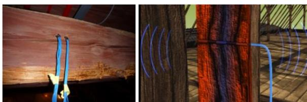
Obr. 13.: Měření změn vlhkosti v různých hloubkách konstrukčního prvku
