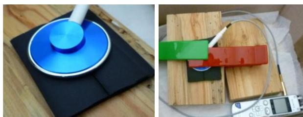
Obr. 16: Ukázka měřicího uspořádání fonendoskopického senzoru s dlouhodobým záznamem
