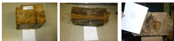
Obr.1: Příklad rozsahu napadení historického dřeva pro podmínky experimentálního měření
