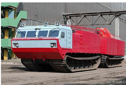
Obr. 3: Vyprošťovací transportér Vityaz vybavený žeriavom FASSI
