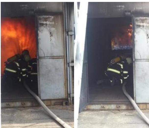
Obr. 3: Vystavení prototypu obleku testu v extrémních podmínkách
