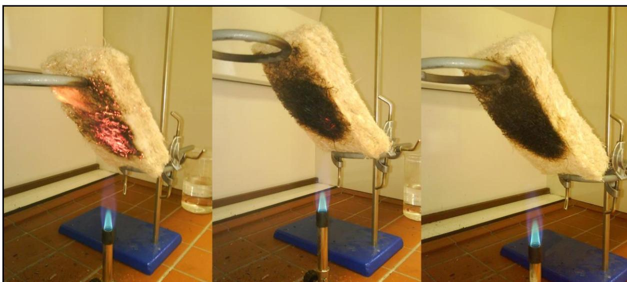
Obr. 6 : Fotky z experimentu - neupravená vzorka, vzorka upravená Ohňostopom špeciál a vzorka upravená Ohňostopom špeciál s prídavkom (zľava doprava)
