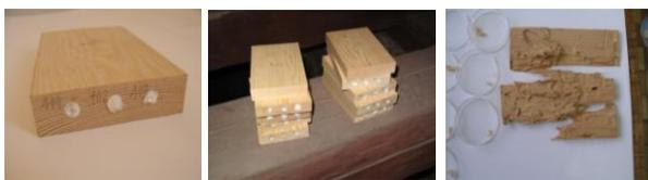
Obr. 15.: Živé kontrolní vzorky ČSN EN 370 infikované tesaříkem krovovým *Hylotrupes bajulus* L.
