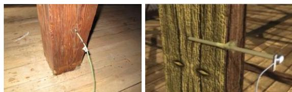
Obr. 8.: Termoelektrické snímače měřící teplotu v průřezu prvku, s ukázkou zaizolování otvoru ovčí vlnou
