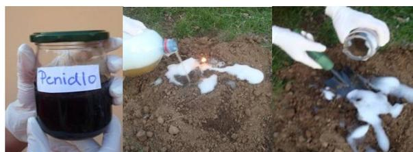
Obr. 5 Vzorka č. 4 Pôda + benzín a jeho následné horenie + uhasenie 6% penotvorným roztokom penidla Solvenseal
