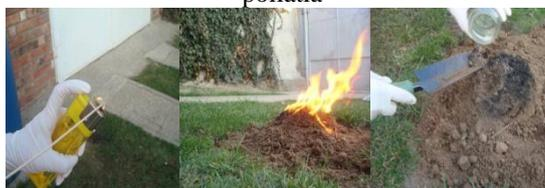
Obr. 4 Vzorka č. 3 Pôda + benzín a jeho následné vyhorenie
