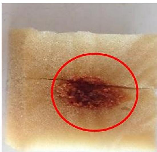
**Obr. 17** Rez vzorky po izotermickom namáhaní 150 °C
