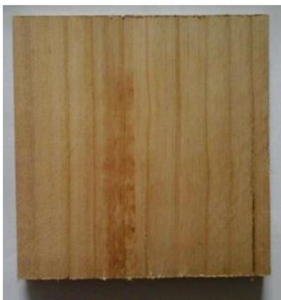
**Obr. 2** Narezaná vzorka dreva – čerešňa
