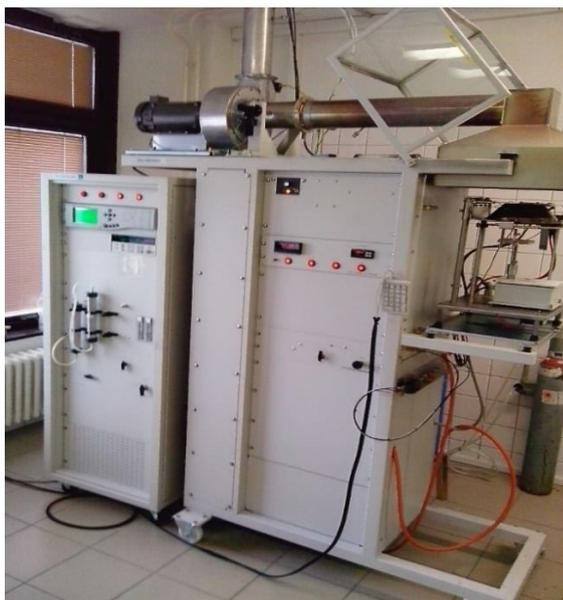
**Obr. 2 Kónický kalorimeter**
