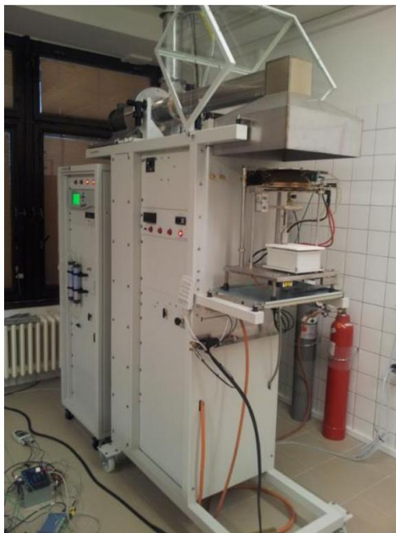
**Obr. 1 Kónický kalorimeter (Kačíková, 2006)**
