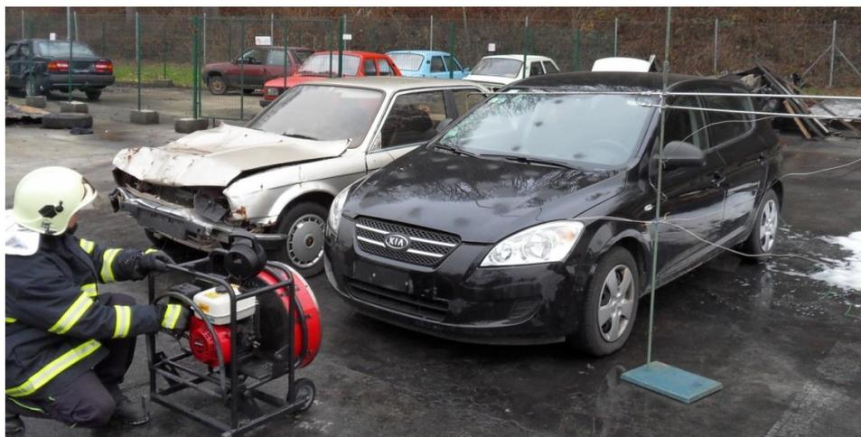
Obr. 2 Umiestnenie pretlakového ventilátora pri simulácii jazdy vozidla
