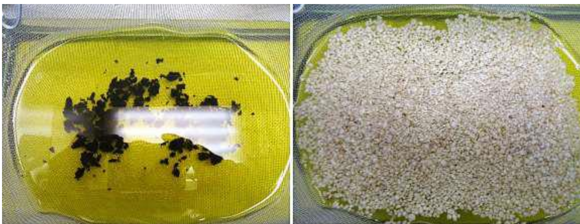
Obr. 2 Skúška krátkodobej adsorpcie ropnej látky. Vľavo univerzálna sorpčná drvina LITE-DRI a vpravo Vapex.
