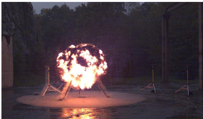
Obrázek 3 Test rovnoměrnosti výbuchu trhaviny Semtex 10-SE, t = 5,236 ms,
