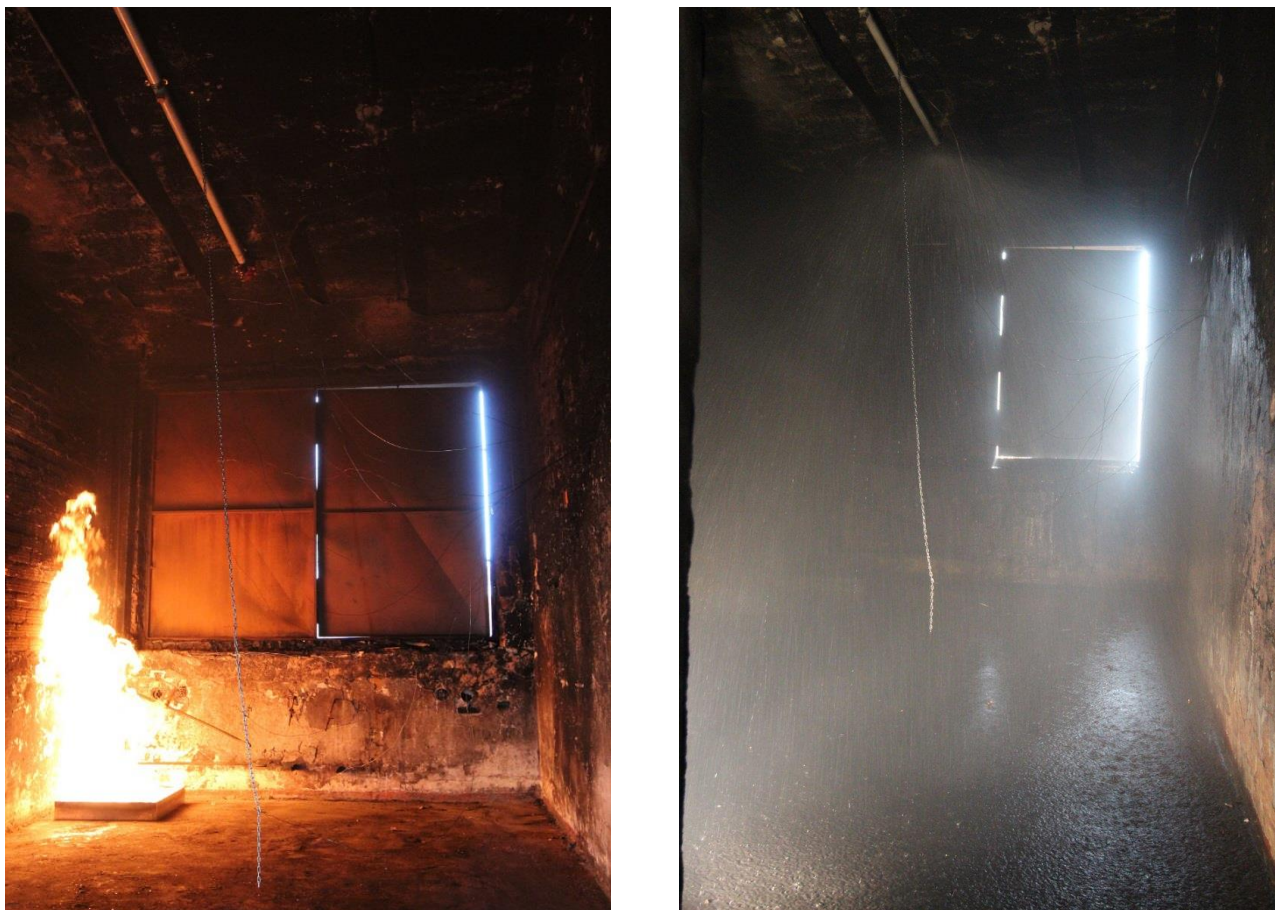
Obrázek 3 Zkušební místnost – po zapálení a po spuštění sprinkleru
