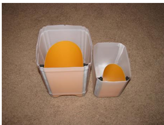
Obrázek 7 a 8 Vyrobené náložky dvou velikostí (vlevo) a s umístěnou trhavinou (vpravo)
