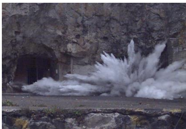
Obrázek 9 a 10 Test improvizované vodní nálože 5 l, t = 0,6 ms a 10 l, t = 1,5 ms
