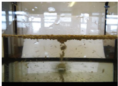
Obr. 3 Porovnanie priebehu sorpcie zo statickej a dynamickej vodnej hladiny. Vľavo Vapex a vpravo hydrofóbná sorpčná drvína LITE-DRI.
